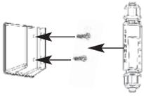
El soporte mantiene el indicador de flujo en posición vertical para su óptima operación.
