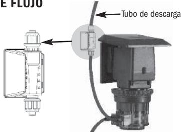
NOTA: Insertar los casquillos con el extremo en punta hacia el indicador de flujo.
