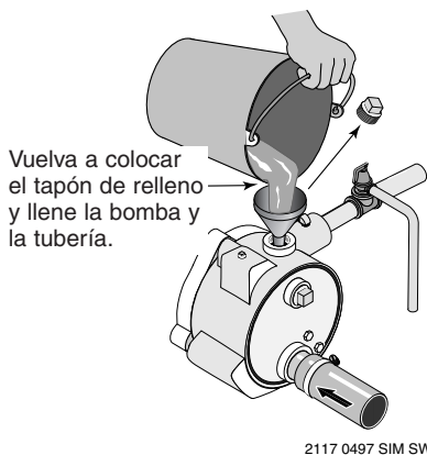
Figura 17: Vuelva a colocar el tapón de relleno y llene la bomba
