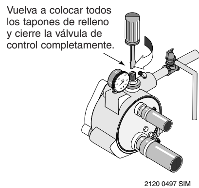
Figura 15: Vuelva a colocar los tapones de relleno y la válvula de control
