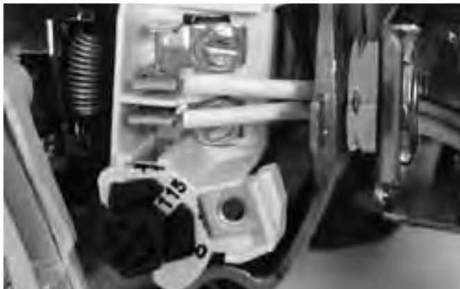
Figure 5 : Tension réglée à 115 V sur sélecteur à cadran
