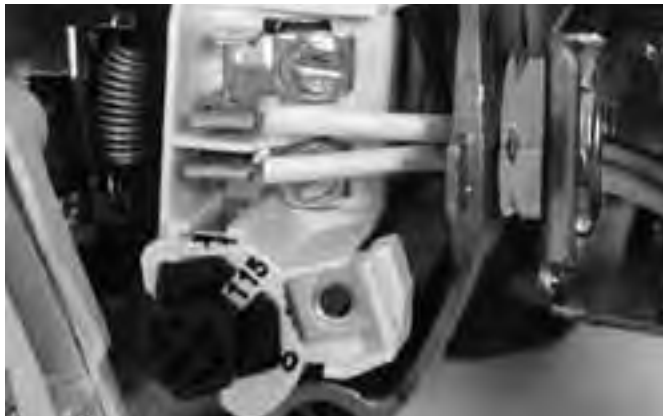
Figura 5: Tensión configurada para 115 V, tipo cuadrante.
