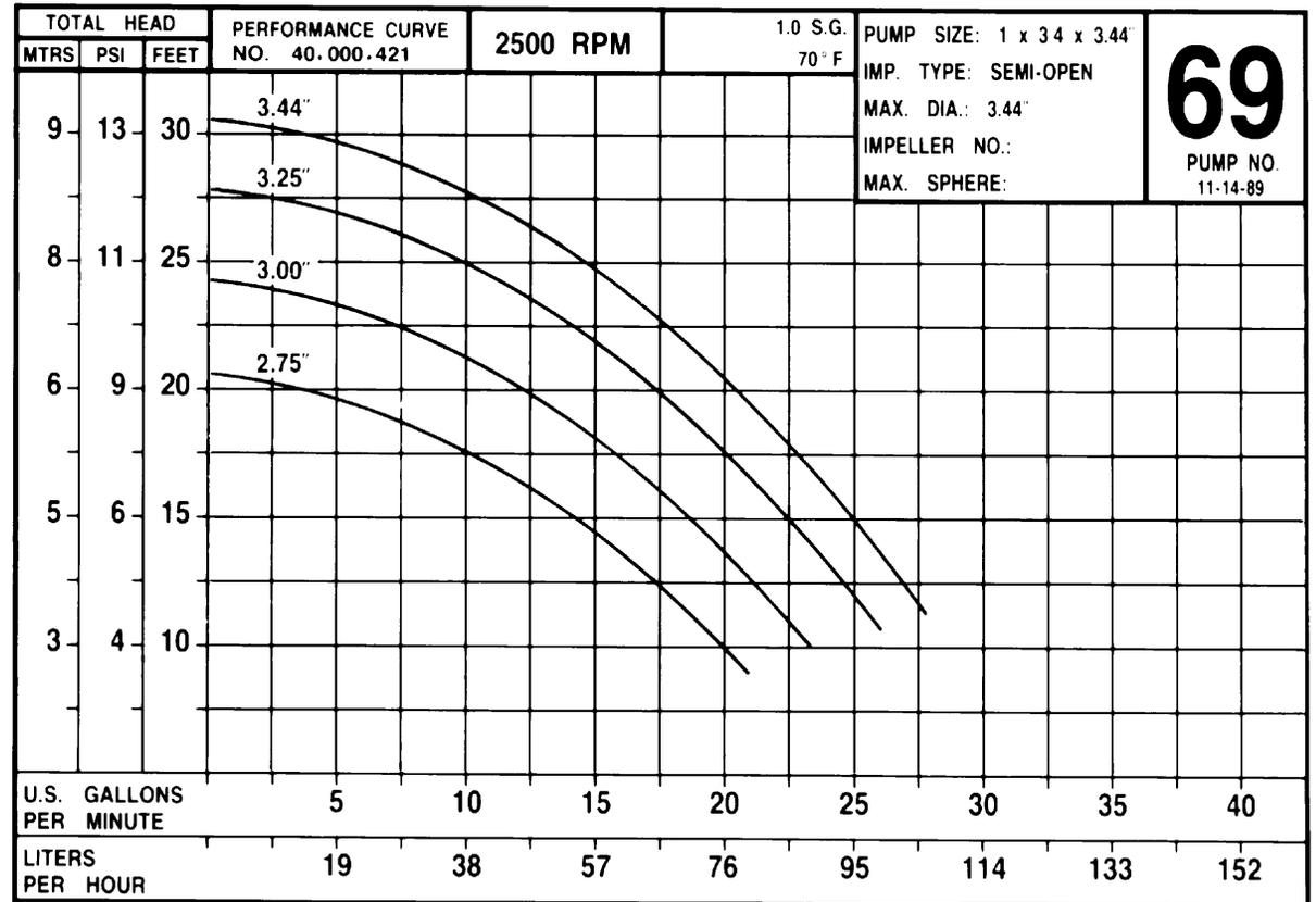
**Pump 69 DC • Iron • J42 Frame • 2500 RPM**
