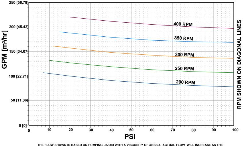
LIQUID VISCOSITY INCREASES. THE LIQUID PUMPED MAY ALSO AFFECT THE FLOW BY CAUSING THE RUBBER GEARS
