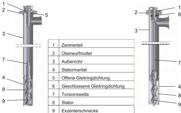
Abb. 1 : Schnitt durch F 550 und F 560
